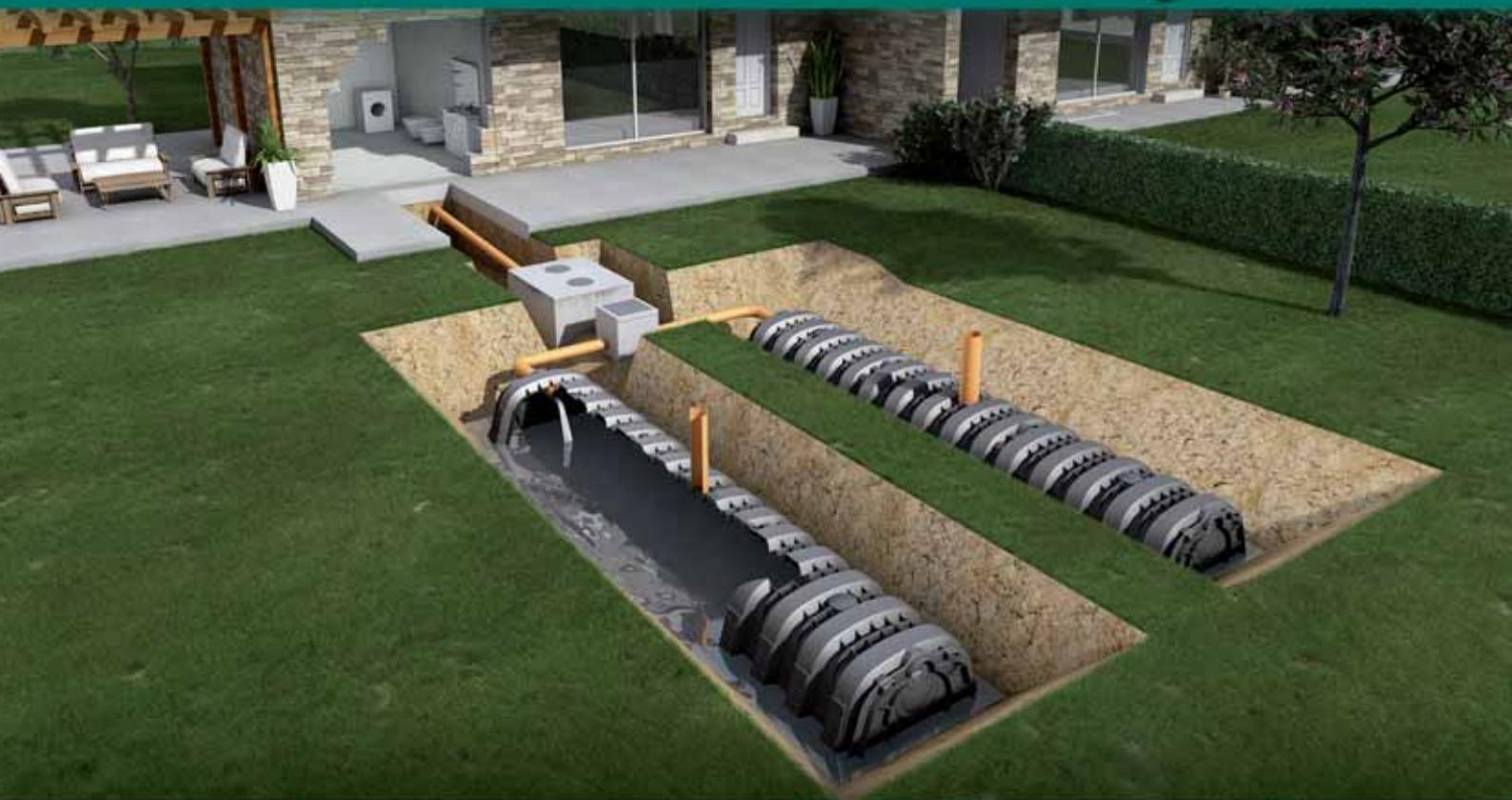
Система обработки сточных вод
